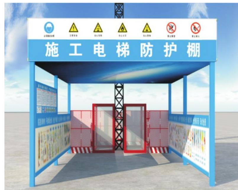
施工电梯防护棚
