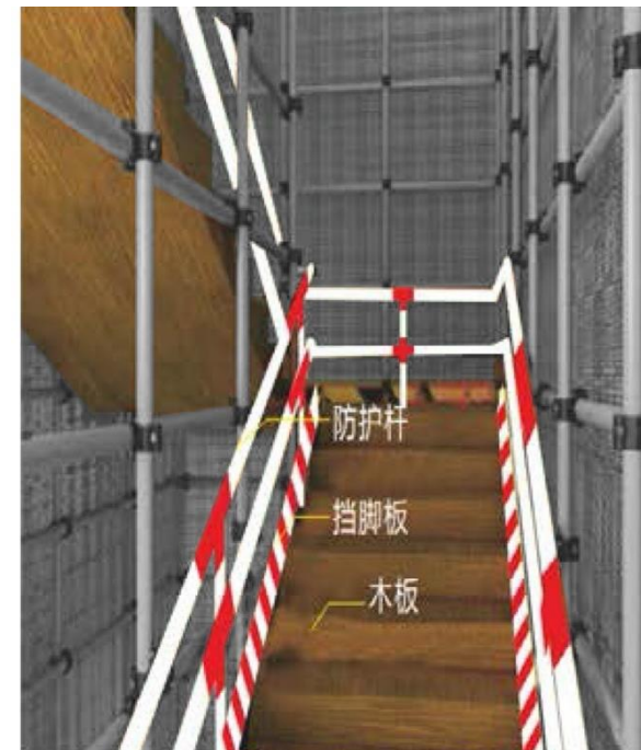
钢管式脚手架通道
