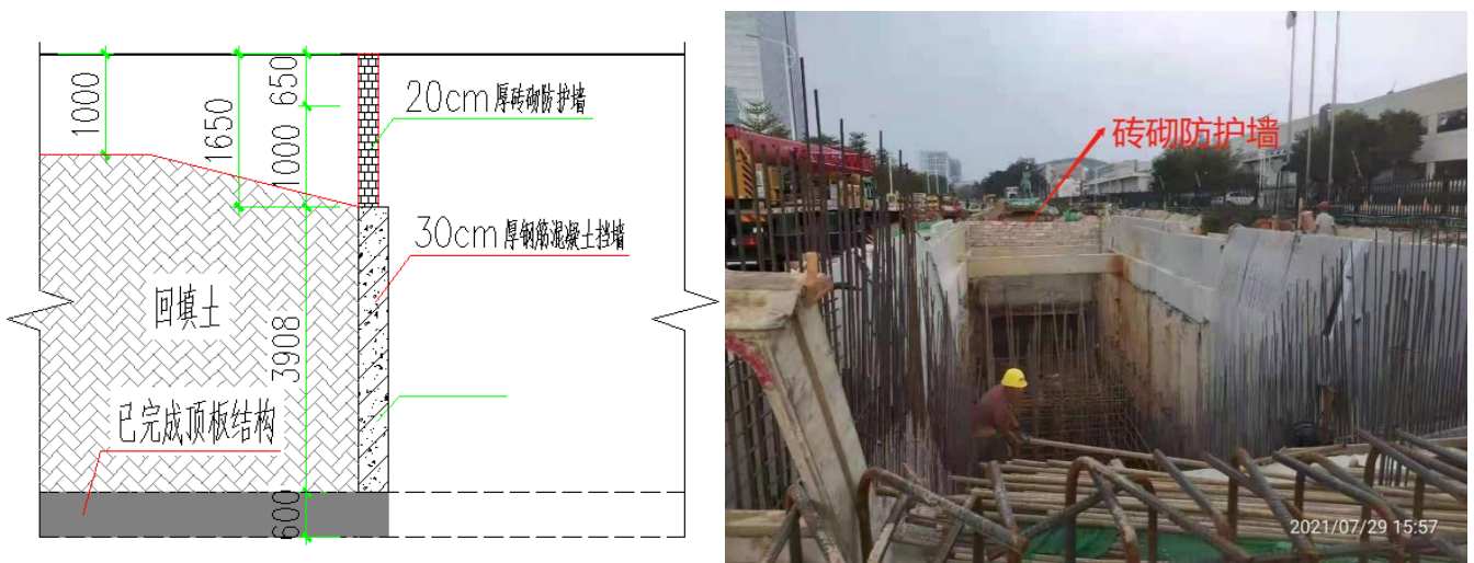
图7 IV号出入口结构顶板上复合临边防护墙剖面 and 现场照片
